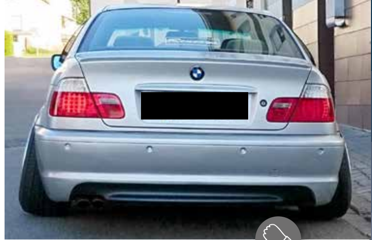
Negativer Sturz an der Hinterachse
