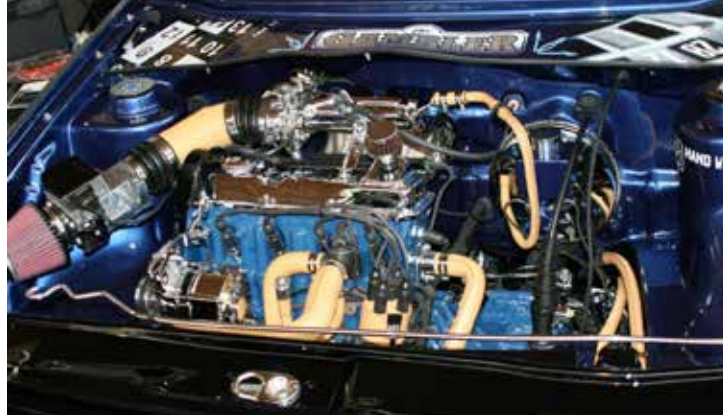
Sportluftfilter und Veränderungen am Ansaugrohr haben Auswirkung auf das Abgas und Geräuschverhalten – Nachweis- und Abnahmepflichtig
