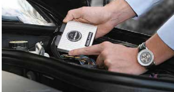
Einbau eines Zusatzsteuergerätes zur Leistungssteigerung
