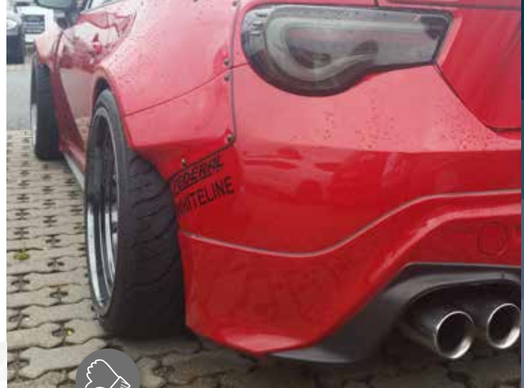
Fahrzeug ohne ausreichende Radabdeckung.
