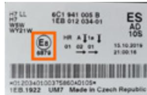
Typenschild Scheinwerfer zur Kompatibilitätsprüfung
